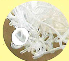
プレスエアー®の構造は中空なので 空気を程よく保ち適度に保温してくれます
